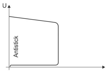
**Antiadherente (antistick) impide el destemplado del electrodo.**
